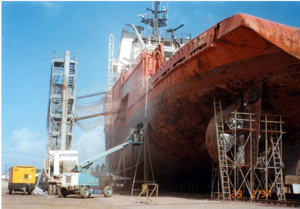
شکل ۳ فرآیند سند بلاست بر روی سازه‌های بزرگ
